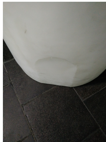
(b) Die ca. 15 cm × 26 cm große plane Abflachung am Boden in der Mantelfläche
