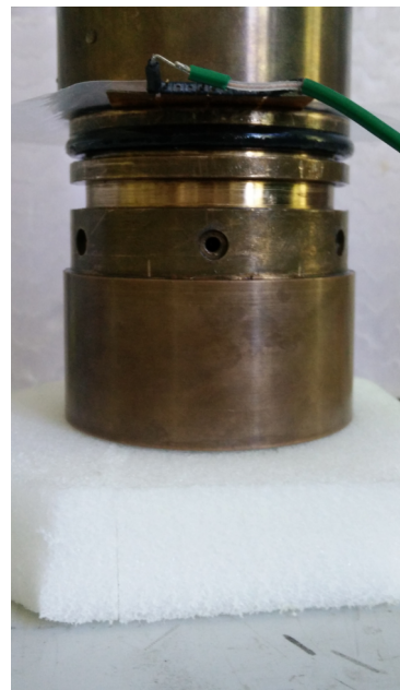
(d) Schaumstoff B und ein weiterer APU-Kopf zwischen Arbeitsplatte und PVDF-Sensor
